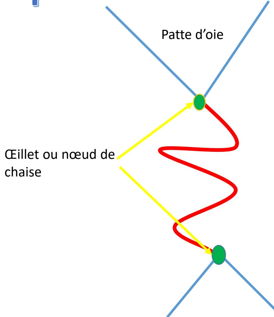
Une bonne « remorque » est constituée d'un bout de 20mm de diamètre minimum et d'une longueur de 15 mètres minimum avec si possible deux œillets à chaque extrémité, qui peuvent être remplacés par deux nœuds de chaise; et, de deux bouts de diamètre inférieur passés dans les œillets ou les nœuds de chaise.
