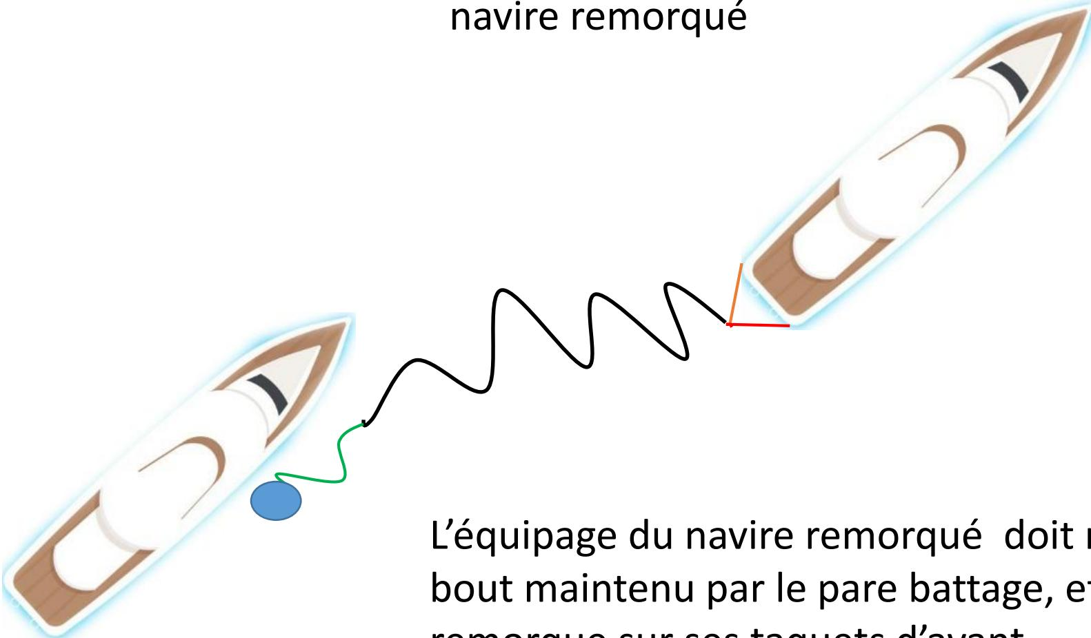
L'équipage du navire remorqué doit récupérer avec une gaffe le bout maintenu par le pare battage, et immédiatement mettre la remorque sur ses taquets d'avant
